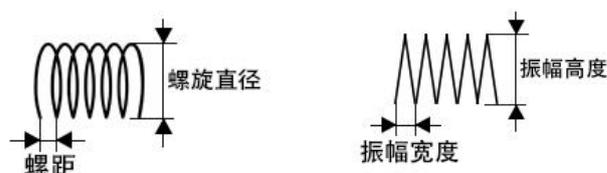
**振幅高度：**设置线性为锯齿时的齿高，线性为锯齿模式的专用参数。
