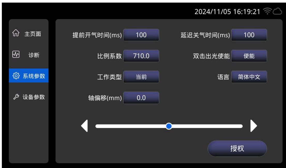
**提前开气时间：**在启动加工时，可以设置延迟开气。当按下外部启动按钮时，先吹气延时一段时间后，然后开始出激光。
