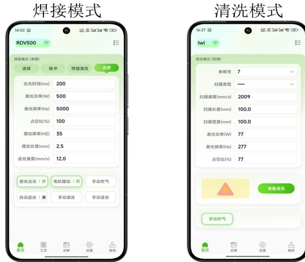
RDWelder 手机 APP 可支持单摆焊接、单摆清洗、双摆焊接、双摆清洗，APP 连接板卡后可自动适配控制卡当前加工模式。
