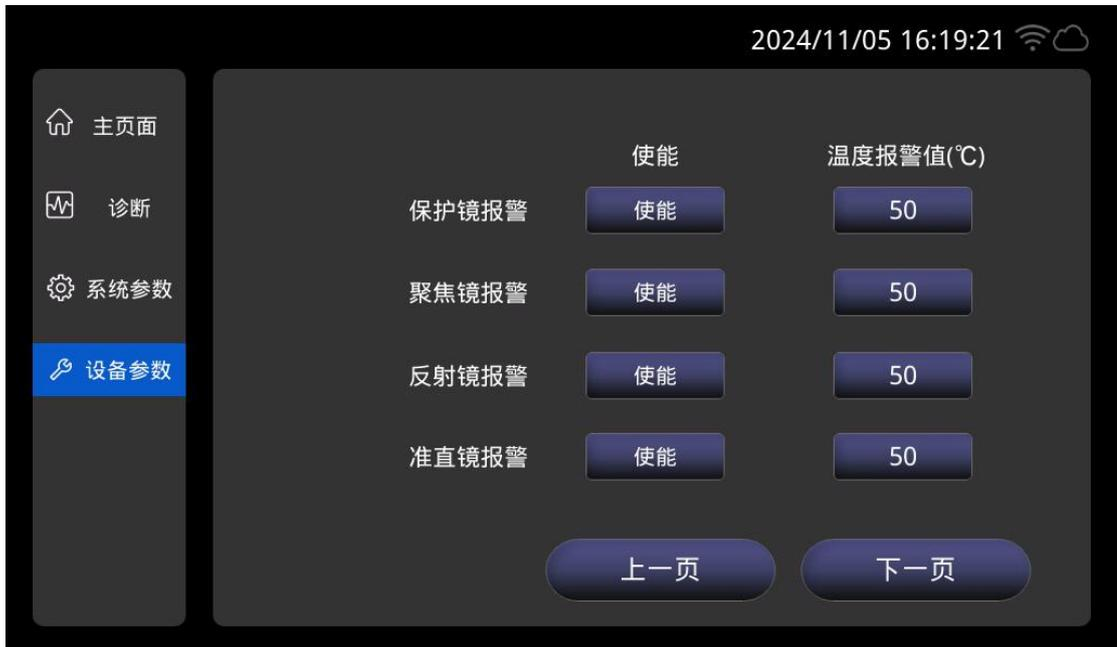
**保护镜报警使能：**是否进行保护镜温度报警检测。
