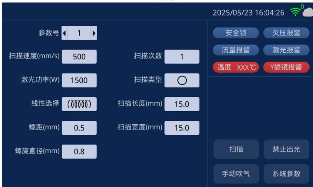
**【扫描参数】**：用于设置振镜扫描加工时相关的参数。
