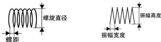
**螺距**：设置线性为螺旋时的螺距，线性为螺旋模式的专用参数。
