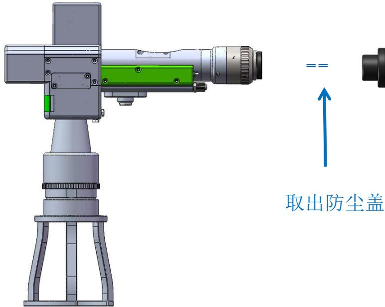
※ 光纤头上红点对准 QBH 红点, 慢慢将光纤头插入 QBH 中。
